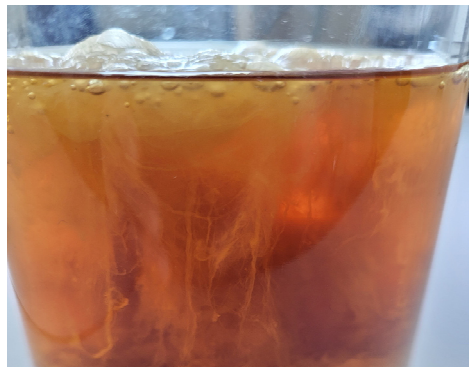
Zdjęcie 1: koagulacja – zbrylanie spowodowane interakcją między polimerem i niekompatybilnymi substancjami drugiego koncentratu środka pianotwórczego
