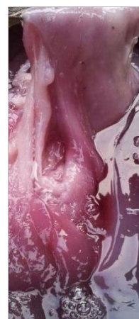
Rysunek 2: Masa gumopodobna powstała w wyniku odparowania wody z koncentratu zawierającego polimer.
